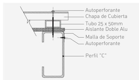
Para el uso de chapa U 45, T 101 o chapa plana similar, en las Zonas Bioclimáticas I, II y III (Argentina) y países Sub-Tropicales y Tropicales, se debe instalar un perfil separador de 25 x 50 mm. o un listón de madera de 2" x 1" para garantizar la vida útil del material, colocado como se describe en el gráfico.
